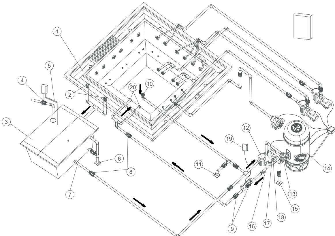
Wasserkreislaufschematische des Spas mit Überlaufrinne
