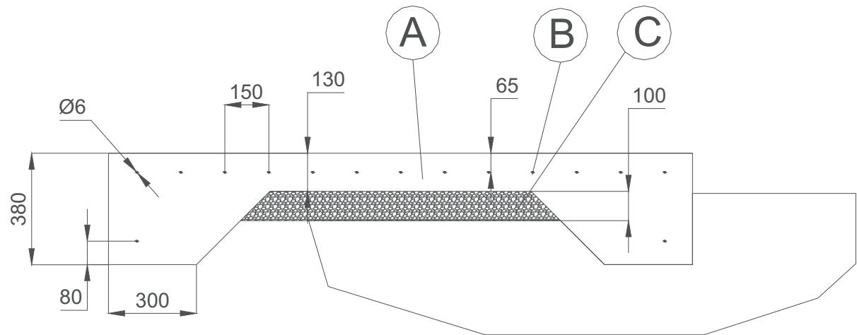
A: Platte aus Stahlbeton B: Stahlstab C: Kompakter Sand
