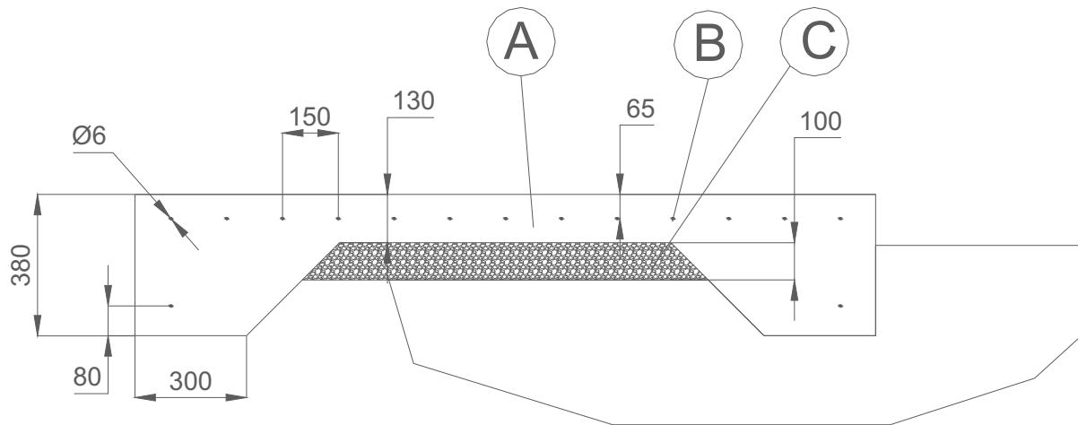
*A: Losa de hormigón B: Varilla de acero C: Arena compactada
