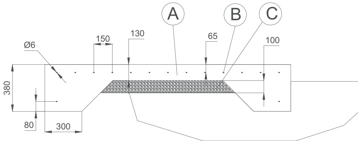
*A: Lastra di cemento armato B: Asta d'acciaio C: Sabbia compattata
