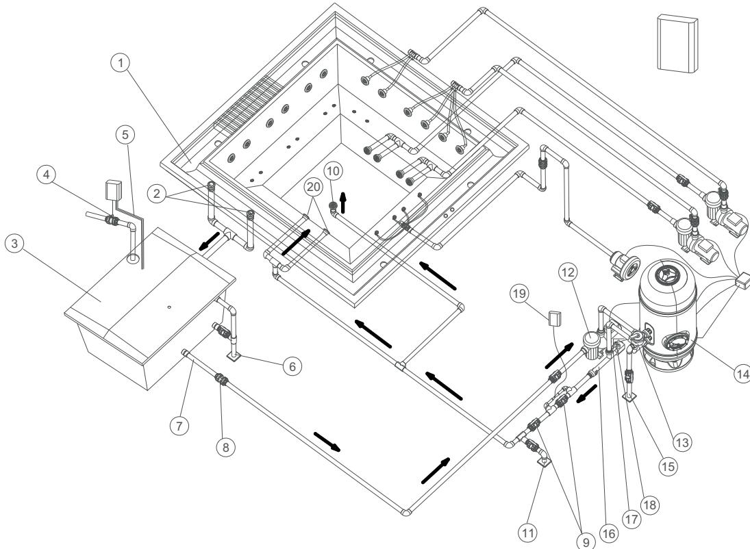
Wasserlaufschema des Spas mit Überlaufrinne
