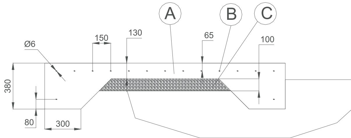
A: Betonsteen B: Stalen staaf C: Compact zand
