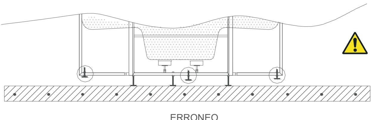
*Schema regolazione altezza Spa.*
