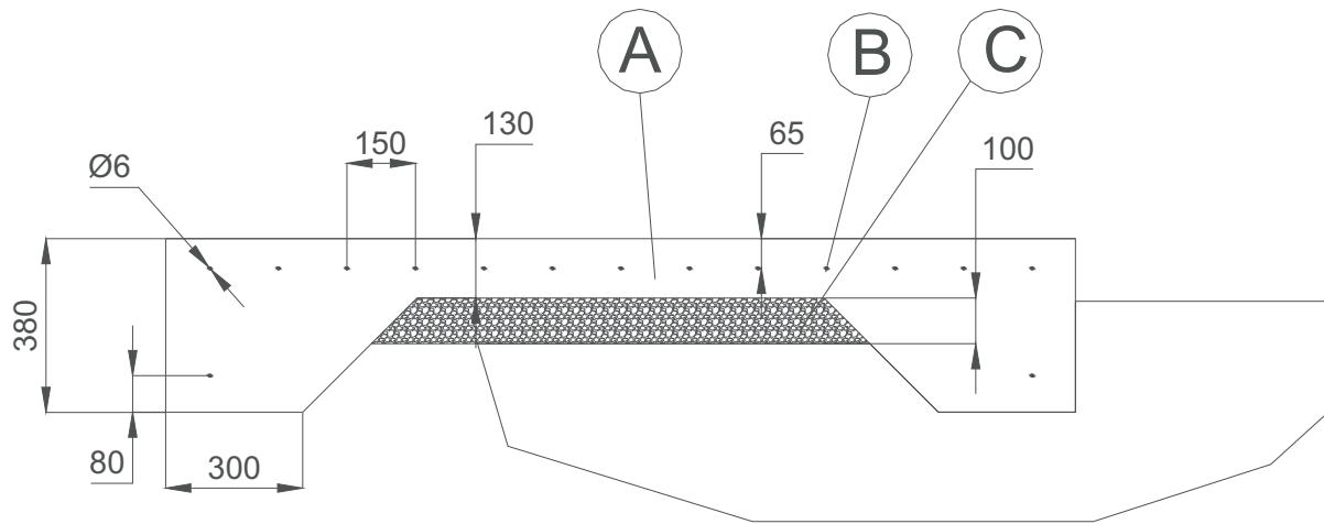
*A: Dalle en béton B: Baguette en acier C: Sable compacté*
