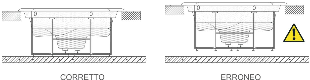
*Schema struttura di supporto Spa.*
