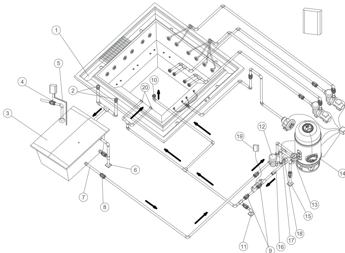
Schema recirculatie Spa met Afvoeling Optie B.
