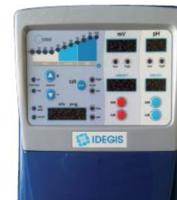
equipo con control de pH y cloro ORP
